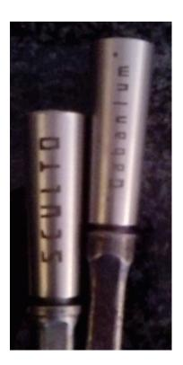
Das Gabanium ist ein Schlagkopf, der auf das Einsteckende von Druckluftmeißeln aufgesetzt wird. Er hält eigenständig und erlaubt feine Arbeiten mit Eisenhämmern oder Knüpfeln. Das Gabianum ist aus Edelstahl gefertigt.
